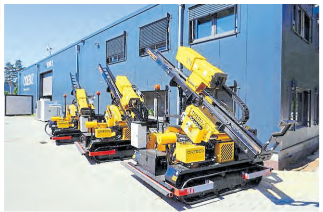
Auch die GPS-gesteuerten Ramm-Maschinen, die für die Montage der Unterkonstruktion von Freiflächenanlagen erforderlich sind, können bestaunt werden. Foto: A. Bitting/Luftbild: Schluse.VT
